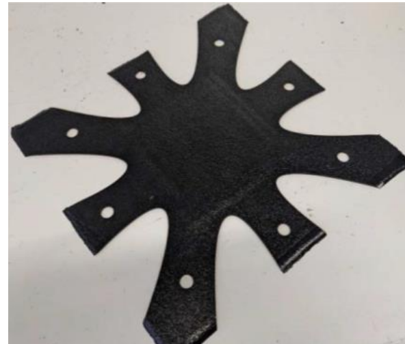
Mehrschichtlaminat mit Elastomer- Einbettung und Randanbindung
