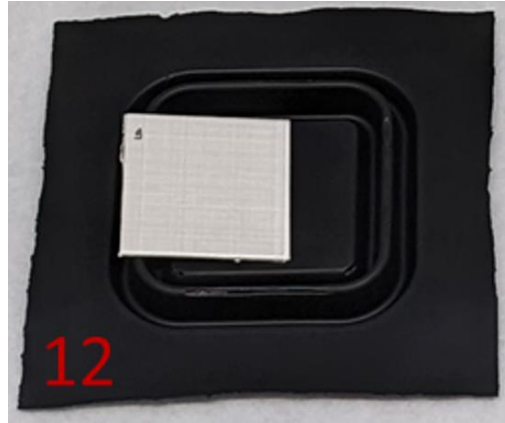
Elastomer-Anbindung mit umlaufender Sicke
